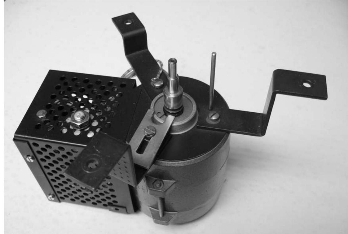
Drehstrommotor mit Phasenschieber
